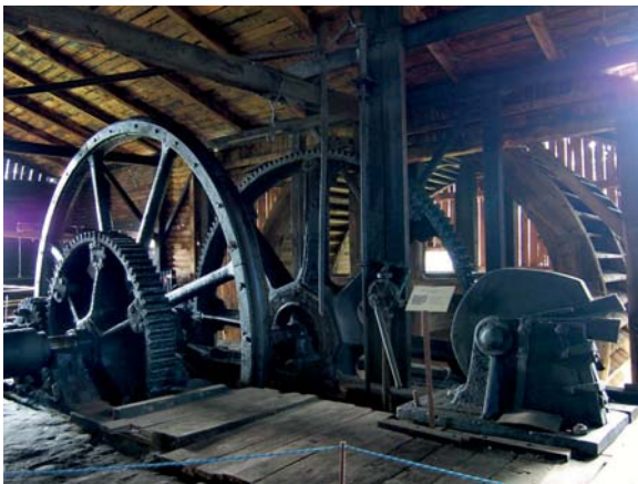
3. Zabytkowy Zespół Walcowni i Gwoździarni w Maleńcu, układ napędowy hali walcowni
